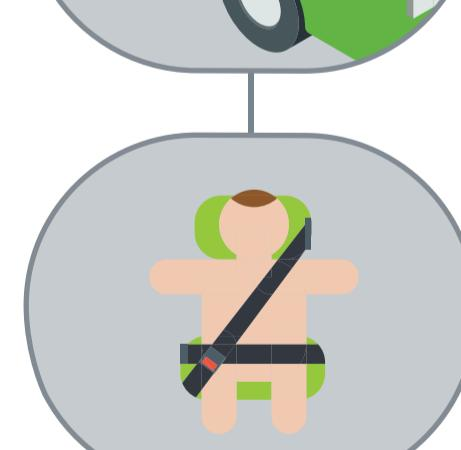
ребенок закрепляется ремнем безопасности – штатная лента должна проходить через направляющие на подголовнике и на нижней части автокресла
