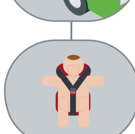
ребенок закрепляется трехточечным ремнем, проходящим через плечи ребенка и между ног
